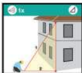
การวัดความสูง ด้วยมุมฉาก ในกรณีไม่สามารถขึ้นยึดขึงได้
