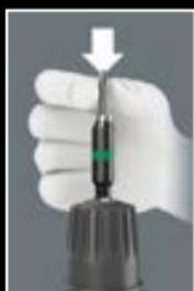
Ohne Betätigung der Hülse kann der Bit in die Aufnahme geschoben werden und wird dann selbsttätig verriegelt.
