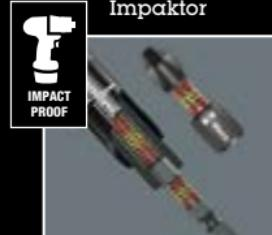
Die Kombination der zweifachen Torsionszonen im Impaktor Halter und der Torsionszone im Impaktor Bit führt zum sogenannten TriTorsion-System = 3fach Schutz für Werkzeug und Schraube.
