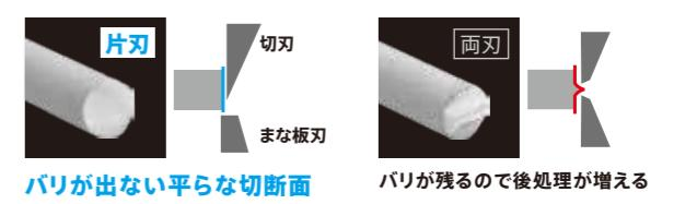
片刃仕様により切断面が平滑で仕上がりがキレイに。まな板刃の上を切刃が削ぐように切り落とすのでバリが残らない。後処理を省き、作業時間を大幅カット。
