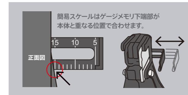
背面の固定ねじを緩め長さを調整し、
