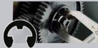
ピン側を軸に、クリップ側をEリングに挟んで握る事で取付け・取外しが簡単に。
