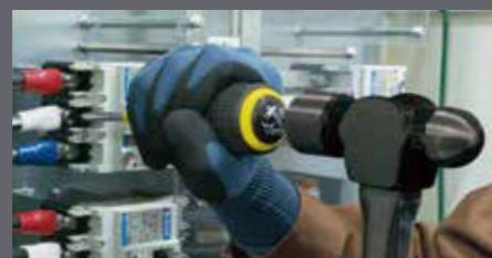
座金に鉄よりも強度なPPガラス繊維入りの強化プラスチック材を採用。さらにアルミより軽量な為、連続使用でも疲れにくい。
