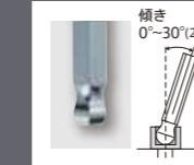
先端に丸い形の「ボールポイント」加工を施したことでの斜めに差し込んだ状態での締め付けが可能。（ねじに対して最大30°の範囲で仮締め）ただし、接触面が少ないため、強いトルクを掛けると先端が破損する恐れがあるので、強い締め付けには向き。
